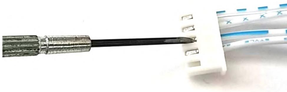
3. Тот провод, который вытащили, надо вставить в крайний разъем до надёжной фиксации.
