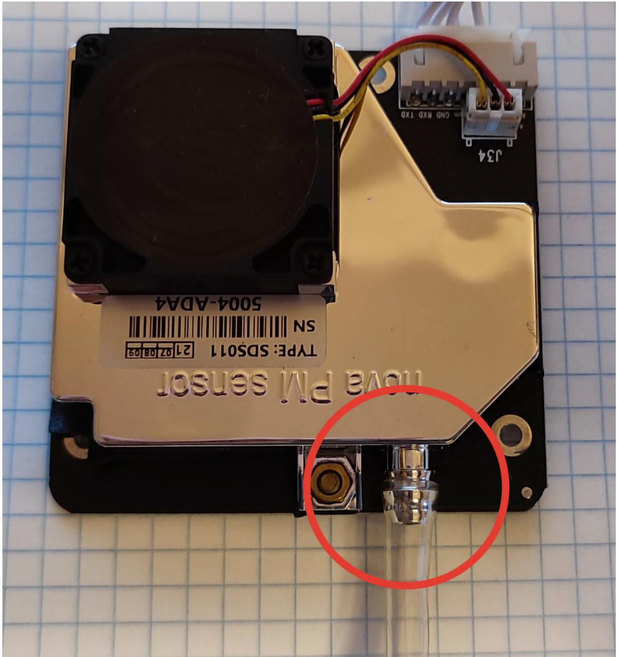
Если корпус большой и трубка позволяет, то можно вставить BME280 в разрез трубки внутри корпуса, но так, чтобы он не касался носика датчика SDS, а лучше отстоял от него хотя бы на 5 мм. Длина разреза должна быть такой, чтобы сенсор смог в него поместиться (~ 1 см).
