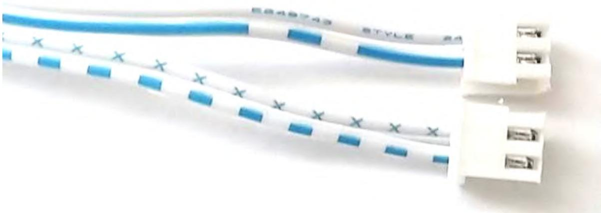
7. Разъемы надо установить во 2 и 3 контакты микроконтроллера, пропустив первый (нумерация с противоположной стороны от разъема USB) (см. рис. ниже).
