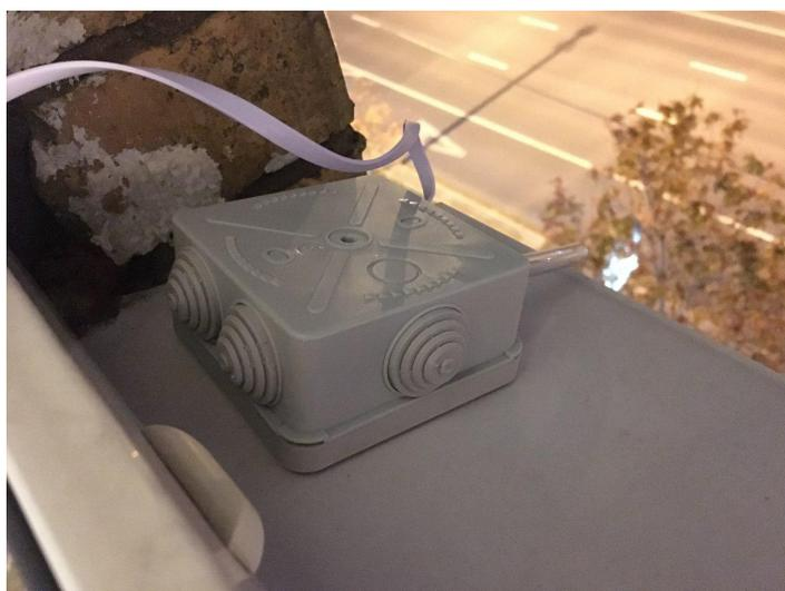
В лежачем положении коробки следите за тем, чтобы датчик SDS011 был ориентирован в коробке вентилятором вниз (как бы лежал на нём), а платой вверх.
