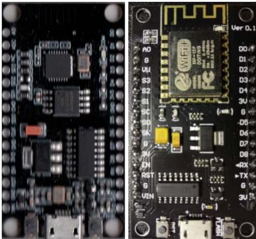
Рекомендованный процессор должен иметь защитную алюминиевую крышку на процессоре. Вот фото:
