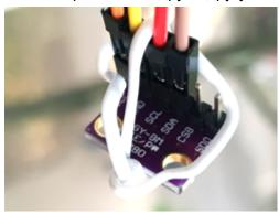
Далее переставьте местами два нижние провода питания и земли (отмечены на плате VCC и Gnd)
